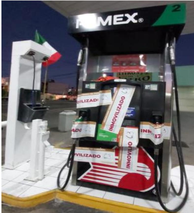
El 1 de octubre del 2020, durante una verificación en la gasolinera con número de permiso PL/9332/EXP/ES/2015, ubicada en Ecatepec, Estado de México, personal de la Profeco detectó que las mangueras para el suministro de combustible utilizadas en dicho establecimiento carecían de verificación para ajuste por calibración de instrumentos de medición.
