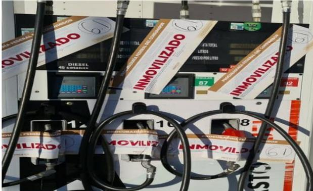
El 1 de octubre del 2020, durante una verificación realizada en la gasolinera con número de permiso PL/10807/EXP/ES/2015, ubicada en Cuautlancingo, Puebla, personal de la Profeco detectó, además de faltantes en el despacho por hasta 644.93 mililitros, que las mangueras para el suministro de combustible utilizadas en dicho establecimiento carecían de verificación para ajuste por calibración de instrumentos de medición.
